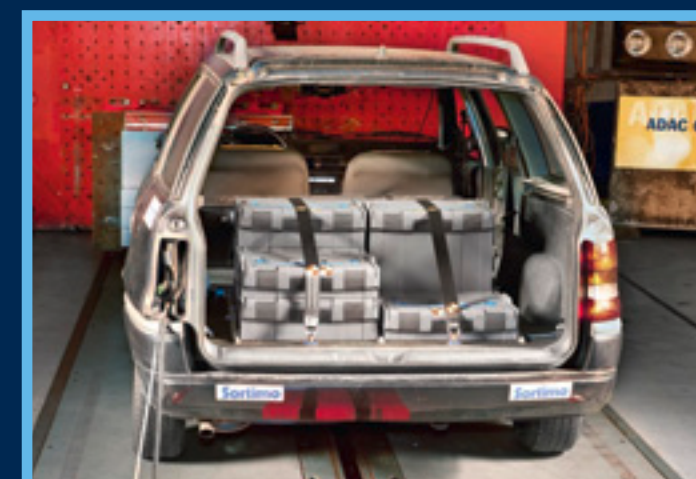
Crashtest ECE 17: Brillantemente superato! Sortimo CarMo è stato sottoposto a un crash frontale a 50 km/h svoltosi presso il centro ADAC e ha guadagnato un ottimo risultato anche a sedili posteriori completamente abbassati.
